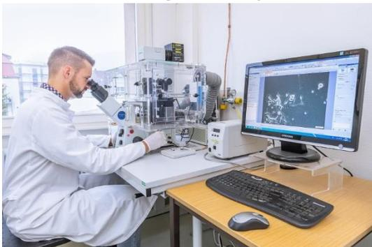
*Unter einem speziellen Mikroskop, zusätzlich ausgestattet mit einer Inkubationskammer, können beispielsweise Zellproben, welche zuvor aus Tumorgewebe isoliert wurden unter in vivo Bedingungen beobachtet werden. Die Anlage erlaubt außerdem die Herstellung von Zeitrafferaufnahme, mit den man die Zellbewegungen und das Zellwachstum über längere Zeiträume erfassen und analysieren kann (Foto: Universitätsklinikum Heidelberg)*
